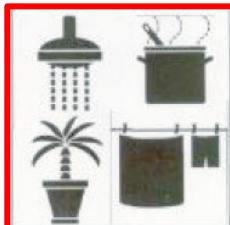
Bekanntlich enthält die Raumluft immer einen gewissen Anteil an unsichtbarem Wasserdampf. Je kälter die Luft ist, desto weniger Wasserdampf kann sie aufnehmen. Kühlt man die Luft ab, so scheidet sie Wasser aus, welches sich vor allem an kalten Bauteilen ansetzt:
